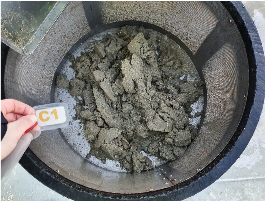
Figur 9-1: Bilde av sedimentet ved C1. Sedimentet besto av sand, skjellsand og grus. Foto: Aqua Kompetanse AS.
