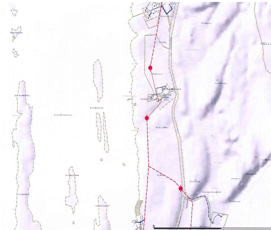
Figur 34. Oversikt over kraftledninger. Fra Nordlandsnett. Rød stiplet linje viser høyspent luftspenn, heltrukket rød linje viser høyspent lagt i kabel. Blå heltrukne linjer er lavspenn, i kabel.
